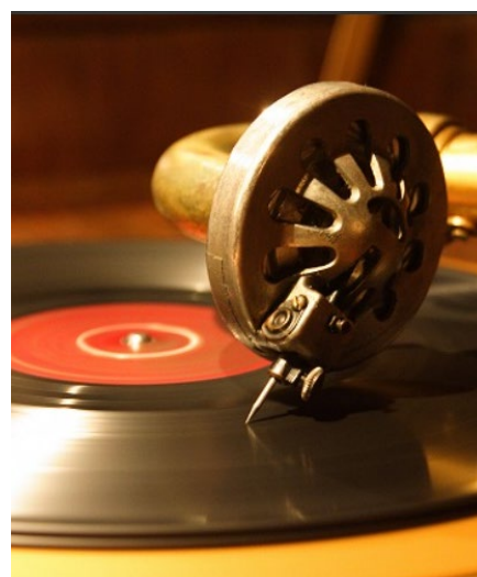
蓄音機のサウンドボックス 下部に丸ネジで留めた針が見える。
